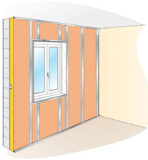
**Figure 2 — Exemple de liaisons menuiseries extérieures – Cas des fourrures**
