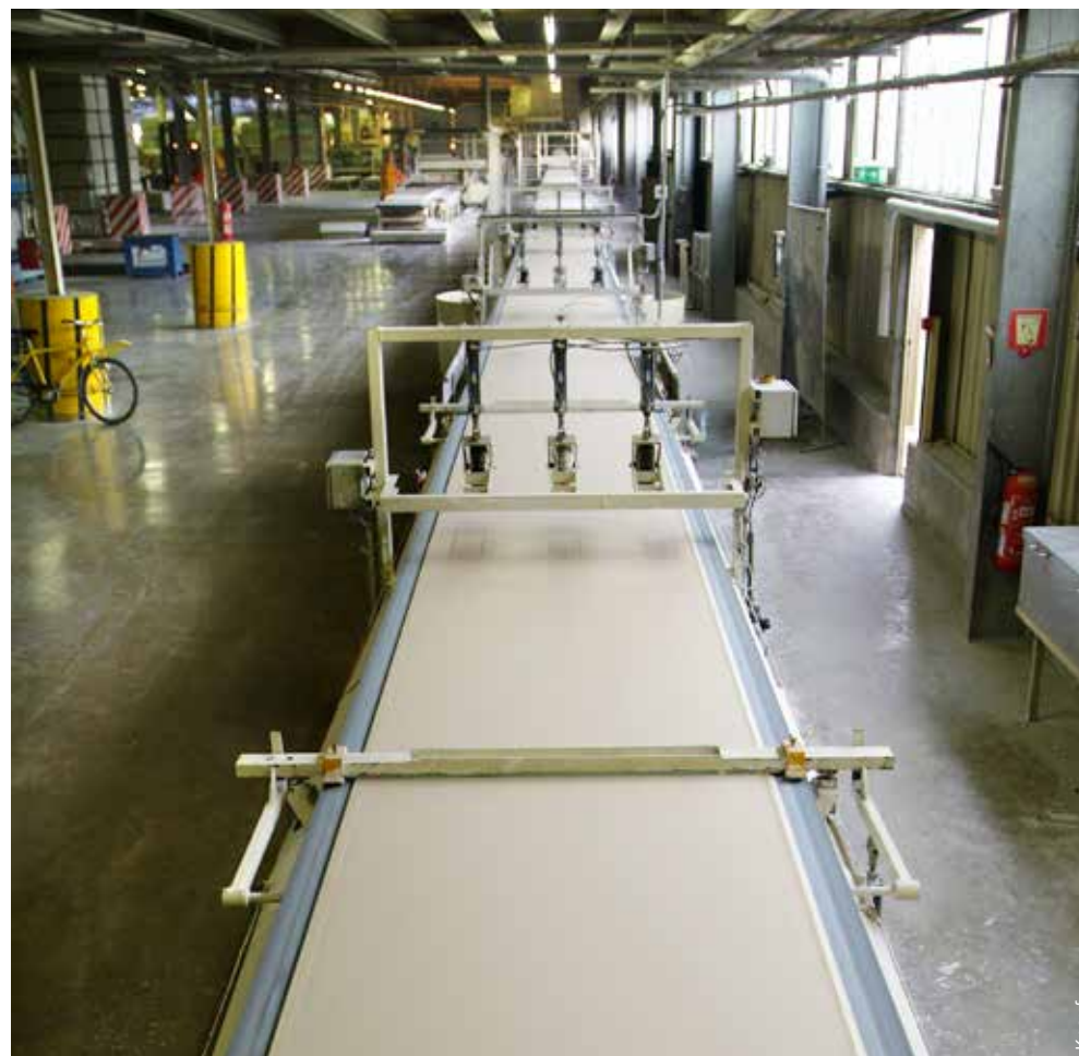
▲ Ligne de production de plaques de plâtre. Usine Knauf (Saint-Souplets, 77).
