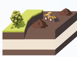
Mise en merlon (buttes)
